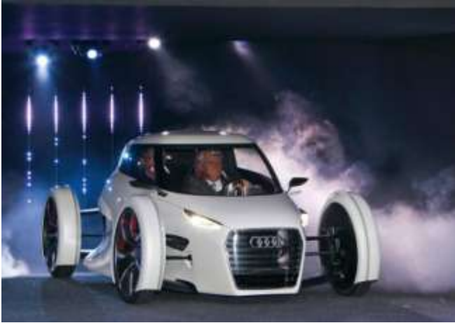
Audi Urban Concept: Karbon-Karosserie, weniger als 500 Kilo Gewicht, 15 kW starker E-Antrieb
